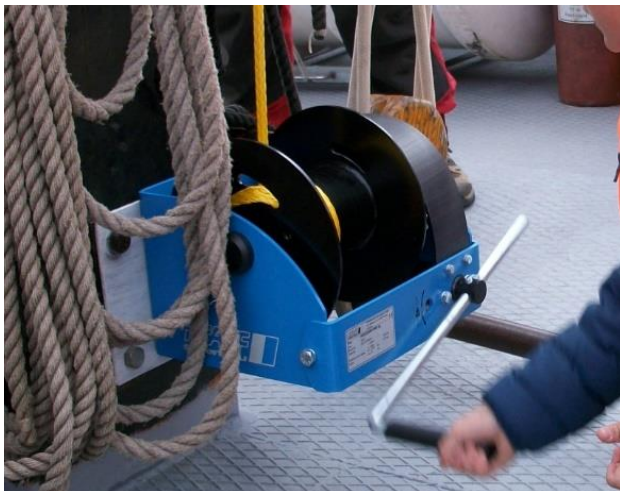
Die neue Dirk zum Anheben des Großbaums und zum Spannen der Fock
