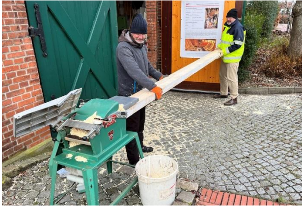
Der provisorische Kielbalken wird auf Maß gehobelt
