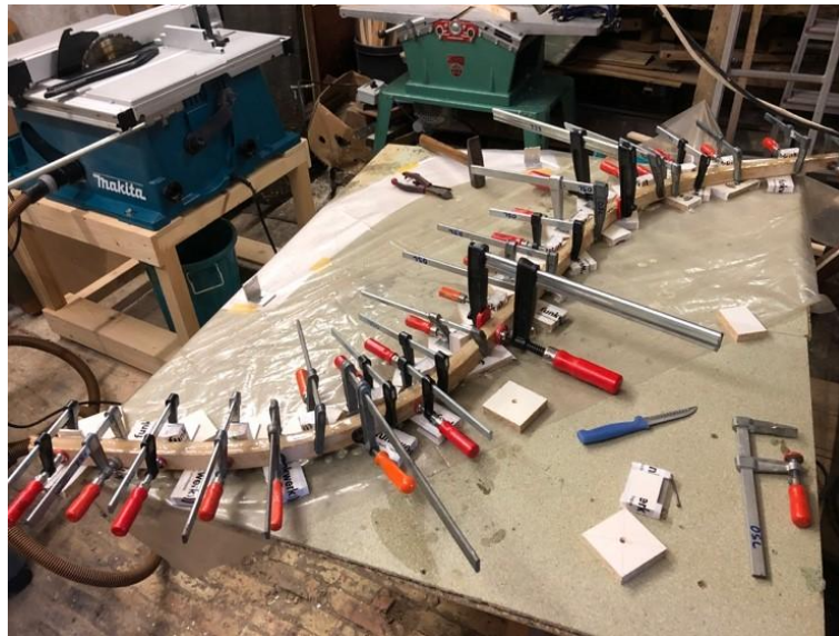
Schraubzwingen halten den neuen Spant in der gewünschten Form
