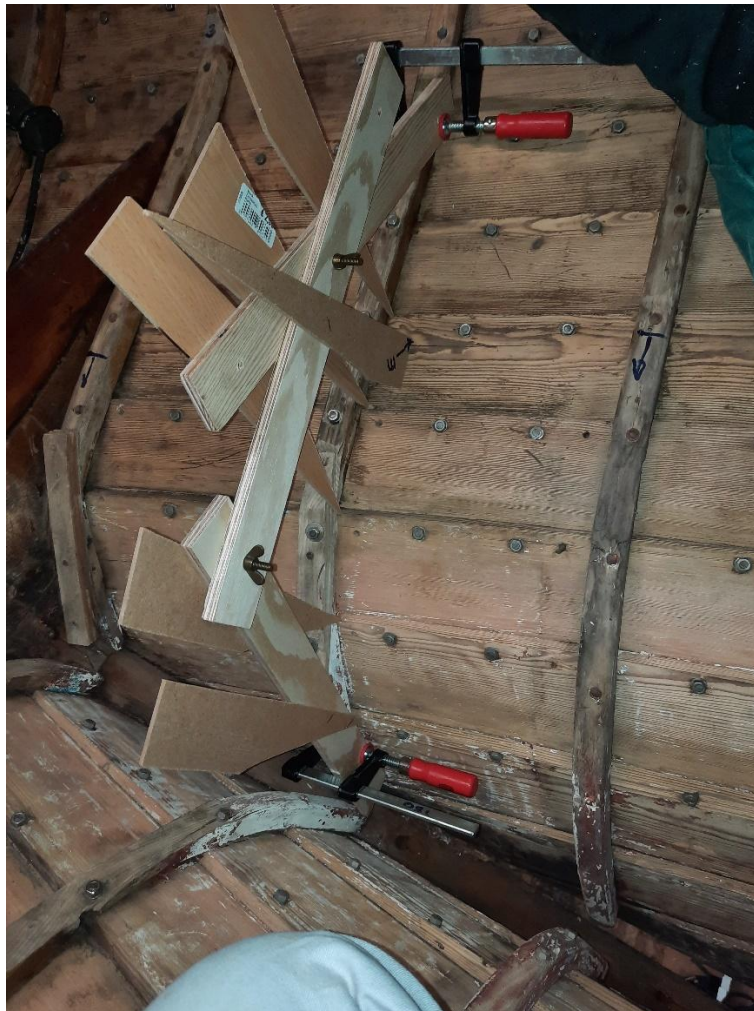
Die Schablone folgt der Spantkontur
