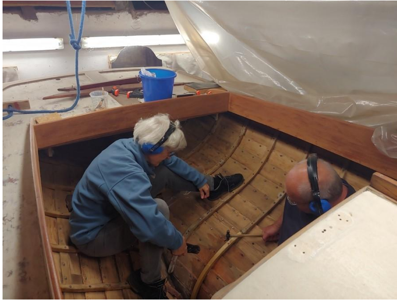
Zu zweit werden die reparierten Spanten mit dem Rumpf vernietet
